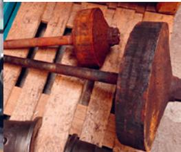
Die beiden stark korrodierten Kolben der Zweizylindermaschine konnten nur mit roher Gewalt und Einsatz von Flüssigstickstoff ausgebaut werden .
