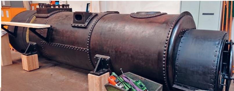
Stand Sommer 2021: Die Dampfmaschine ist abgebaut, der Kessel entrostet und konserviert.
